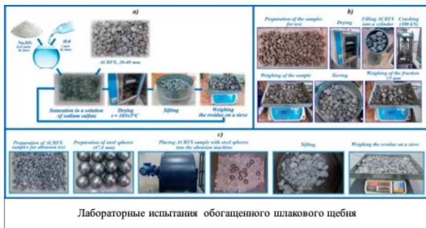
Рисунок 12 – Лабораторные испытания обогащенного шлакового щебня
