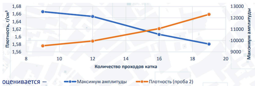
Рисунок 4 - Зависимость амплитуды сигнала георадара от плотности грунта с учетом количества проходов катка
