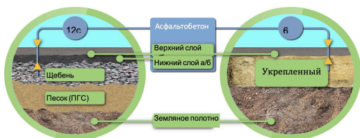
Рисунок 3 – Сравнительная схема конструкции дорожной одежды
