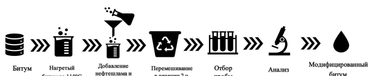
Рисунок 2 – Схема модификации битума с использованием нефтешлама
