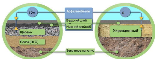
Рисунок 3 – Сравнительная схема конструкции дорожной одежды
