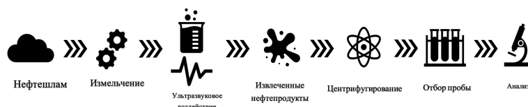
Рисунок 1 – Схема подготовки нефтешлама к лабораторному анализу
