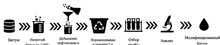
Рисунок 2 – Схема модификации битума с использованием нефтешлама
