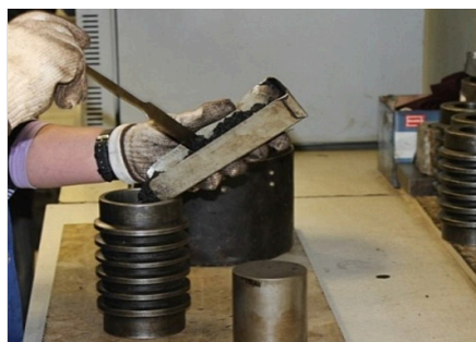
Рисунок 1 - Приготовление образца асфальтобетона в лабораторных
