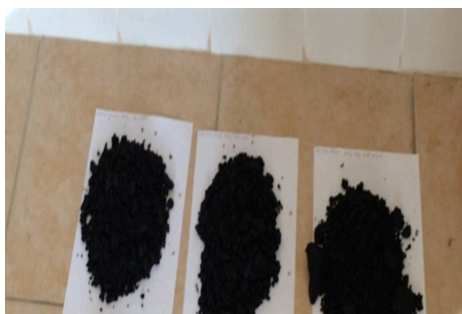
Рисунок 1 - Приготовление образца асфальтобетона в лабораторных
