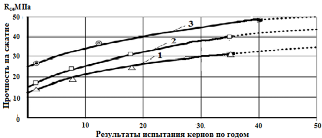
Рисунок 1. Многолетнее упрочнение самовосстанавливающихся дорожных бетонных покрытий, со слоем износа из асфальтобетона на автомобильных дорогах, построенных в 1976-1984 гг.: где бетоны на основе белитовых цементов и вяжущих из ТМО:
