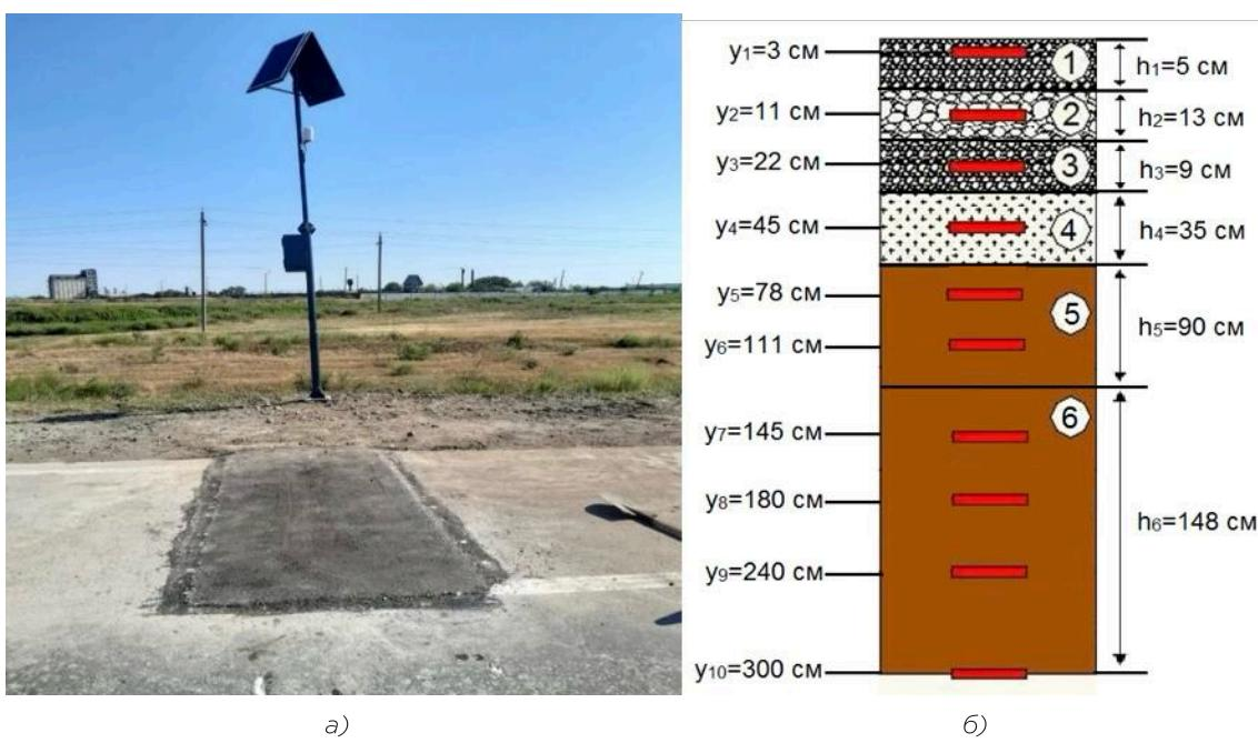
Рисунок 1 – Внешний вид передающей антенны вблизи г. Костанай а) и схематический вид дорожной конструкции б)
