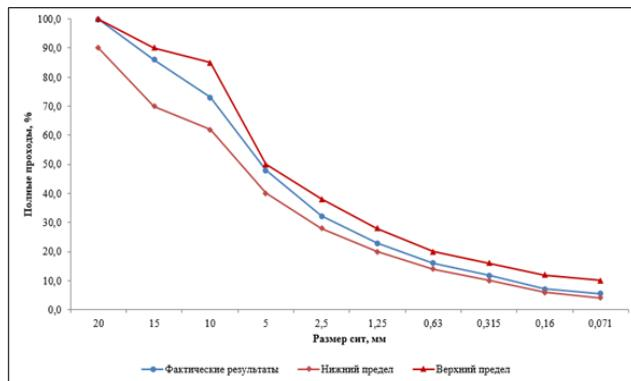
Рисунок 2 – Кривая гранулометрического состава асфальтобетонной смеси типа А
