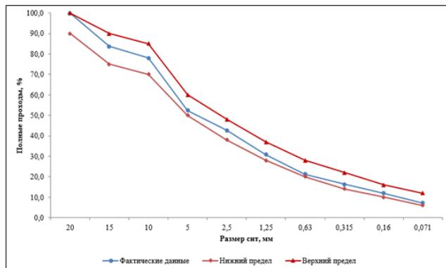
Рисунок 1 – Кривая гранулометрического состава асфальтобетонной смеси типа Б
