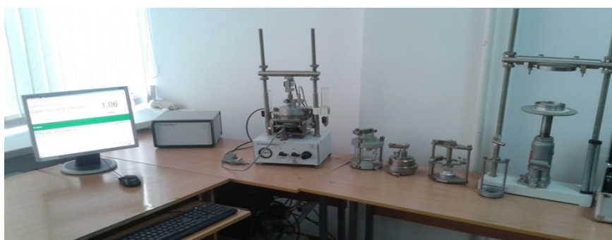
Рисунок 6 - Комплекс измерительно-вычислительный АСИС-1 Figure 6. ASIS-1 measuring and computing complex
