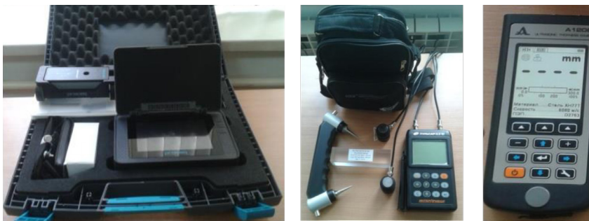
Рисунок 3 – Приборы по неразрушающему контролю а) прибор для поиска арматуры и измерения защитного слоя бетона Profometer PM-630; б) измеритель времени и скорости распространения ультразвука Пульсар-2.2; в) толщиномер ультразвуковой А 1208
