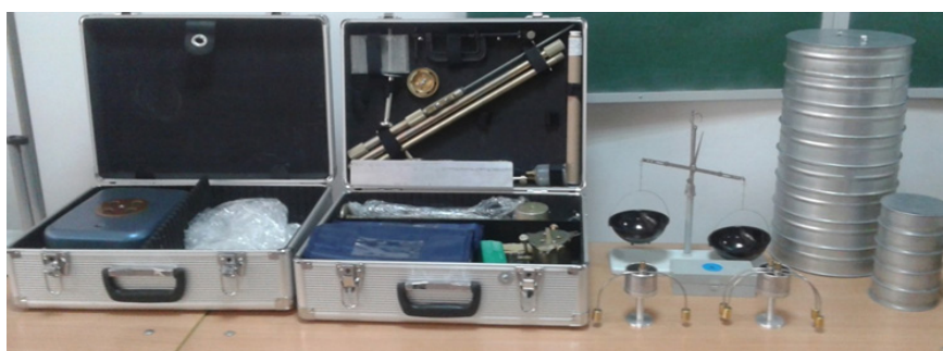
Рисунок 7 - Полевая лаборатория ПЛЛ-9 Figure 7. PLL-9 field laboratory
