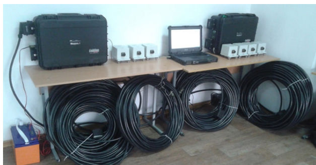
Рисунок 1 - Тензометрический измерительно-вычислительный комплекс для измерения относительных деформаций и напряжений в конструкциях Figure 1. Strain gauge measuring and computing complex for measuring relative deformations and stresses in structures
