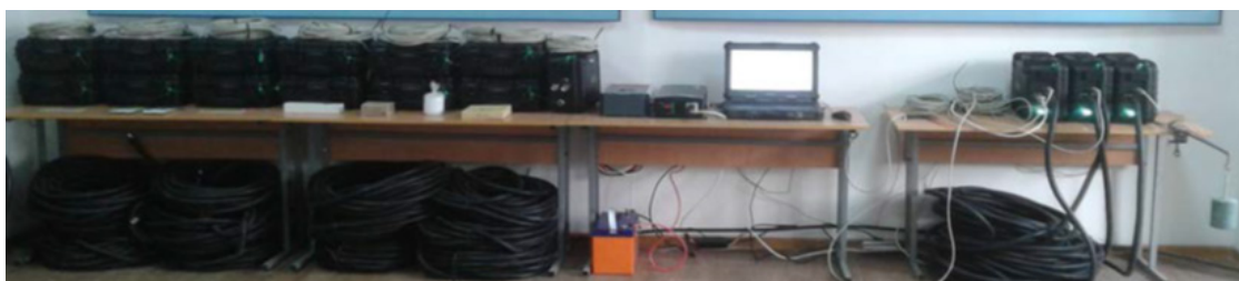
Рисунок 1 - Тензометрический измерительно-вычислительный комплекс для измерения относительных деформаций и напряжений в конструкциях Figure 1. Strain gauge measuring and computing complex for measuring relative deformations and stresses in structures
