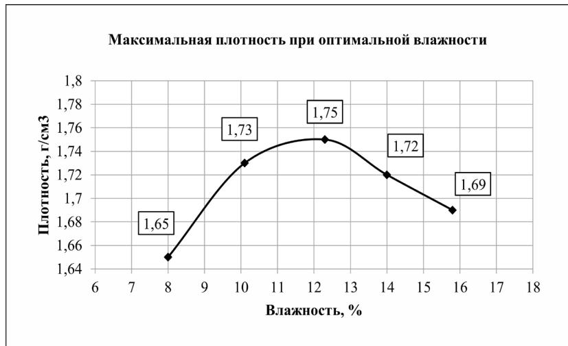
Рисунок 1 – Зависимость плотности состава от влажности
