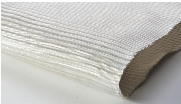
Рисунок 6. Материал геотекстильный рулонный Stabudtex 150/50
